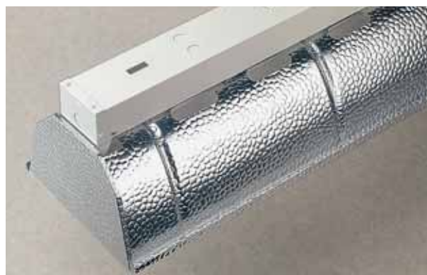
Com os entalhes dos uplight, é criada uma circulação de ar direccional que impede depósitos inconvenientes de poeira no reflector.
